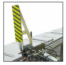
Riscontro di misura motorizzato a controllo numerico (Optional) OPTIONAL
